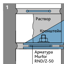
Шов с кронштейнами 12 - 15 мм
