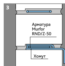
Пониженный шов с арматурой и хомутами 8 - 9 мм
