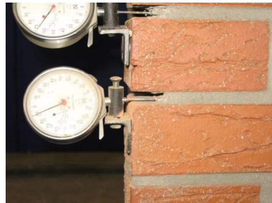
13 pav. Armatūros išsitraukimo matavimai
