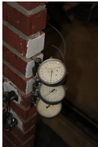
13 pav. Armatūros išsitraukimo matavimai
