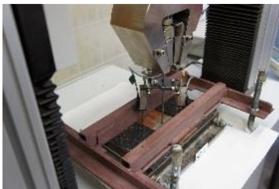
6 pav. Bandymo schema ir bendras vaizdas: a- schema, b- bendras vaizdas, 1- keraminės plytos, 2 – gulsčioji siūlė, 3 lankstusis ryšys, 4- tarpinė, 5- rėmas, 6- templės, 7- spyruoklės, 8 – horizontalioji templė
