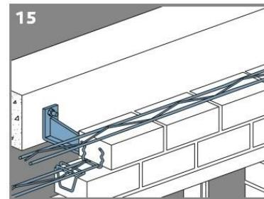
Показан монтаж кронштейна при горизонтальной кладке. Монтаж кронштейна аналогичен при всех типах кладки.
