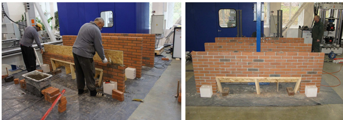
6 pav. Apdailinio mūro sąramų (bandinių) bendras vaizdas
