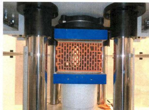
5 pav. Porotherm 25P+W blokų bandymo bendras vaizdas: a – apkraunant statmenai guldomajam paviršiui ir b – statmenai tušymėms
