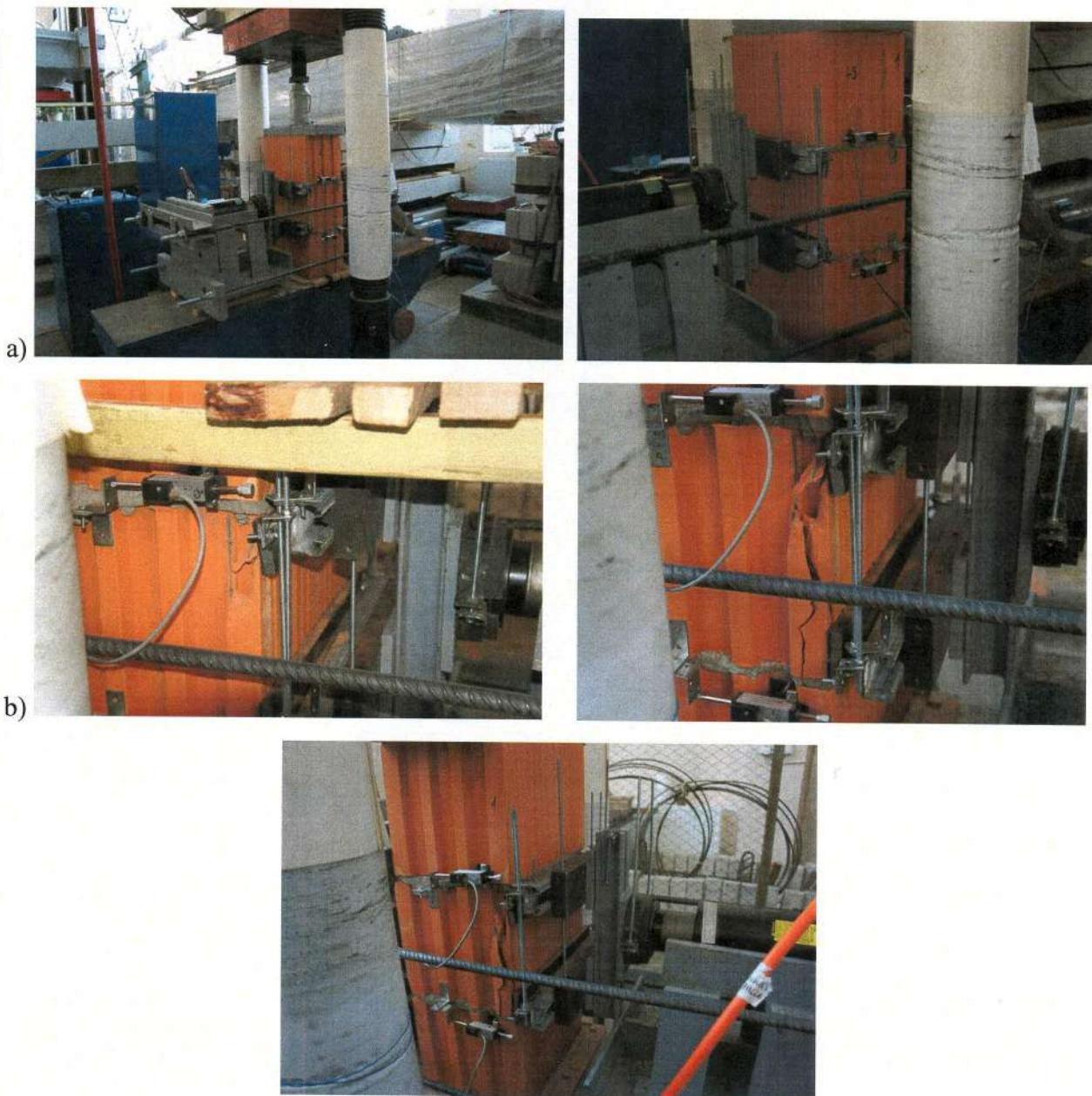
6 pav. Mūro kerpamojo stiprio bandymo schema ir bendras vaizdas (a) bei irties pobūdis (b)
