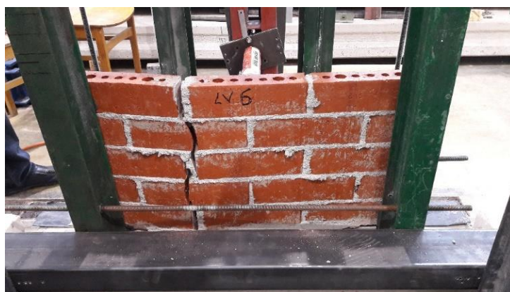
10 pav. Mūro bandinių schema ir bendras bandymo ir irties vaizdas: a – bandinio schema, b – bendras bandymo vaizdas, c- irtis per perrištą mūrą
