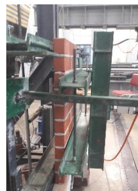
9 pav. Mūro bandinių schema ir bendras bandymo vaizdas: a – bandinio ir bandymo schema, b – bendras bandymo vaizdas
