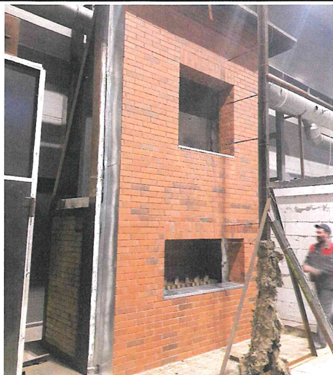
Рисунок 3. Общий вид образца НФС до испытаний.
