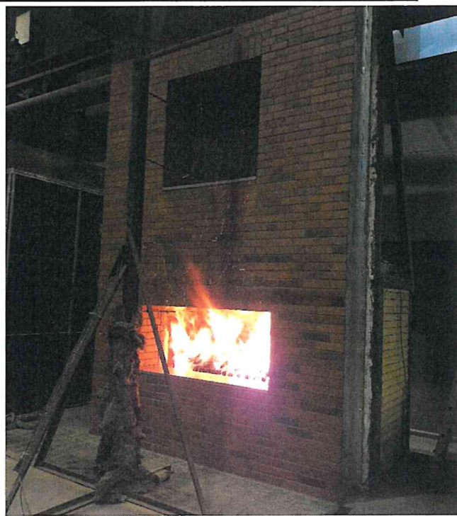
Рисунок 4. Общий вид образца НФС в начале испытаний.
