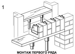
Доведя облицовочную кладку до уровня перемычки, сооружается опалубка, на которую укладывается первый ряд кирпичей, располагая между ними хомуты SKK 50-170. Хомуты
