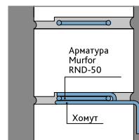
Пониженный шов с арматурой и хомутами 8 - 9 мм
